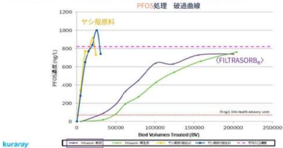
図3 PFOA除去のRSSCT-4種のGACの破過曲線 ※図 株式会社クラレ提供
